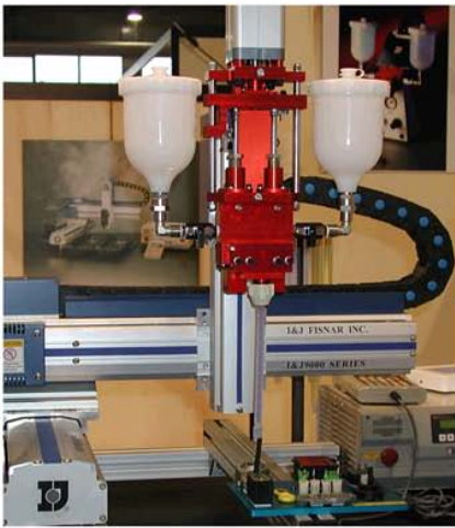
Dosatore IOTA-R montato su robot cartesiano
